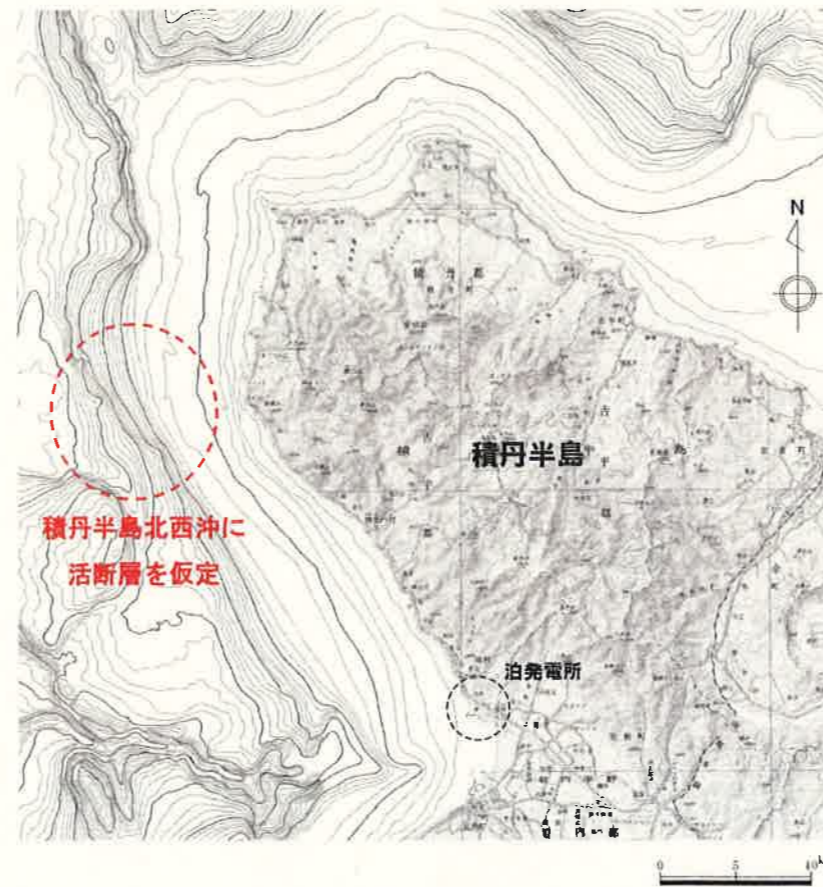
活断層の仮定位置
